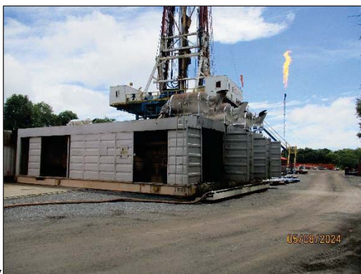
ภาพถ่ายที่ 2.2-7 ตู้ครอบเก็บเสียงเครื่องกำเนิดไฟฟ้า
